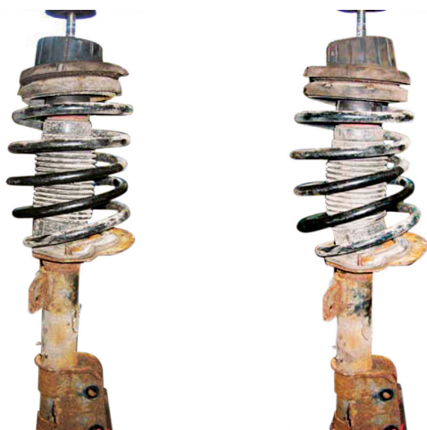
Korrekt montierte Kopfplatte
